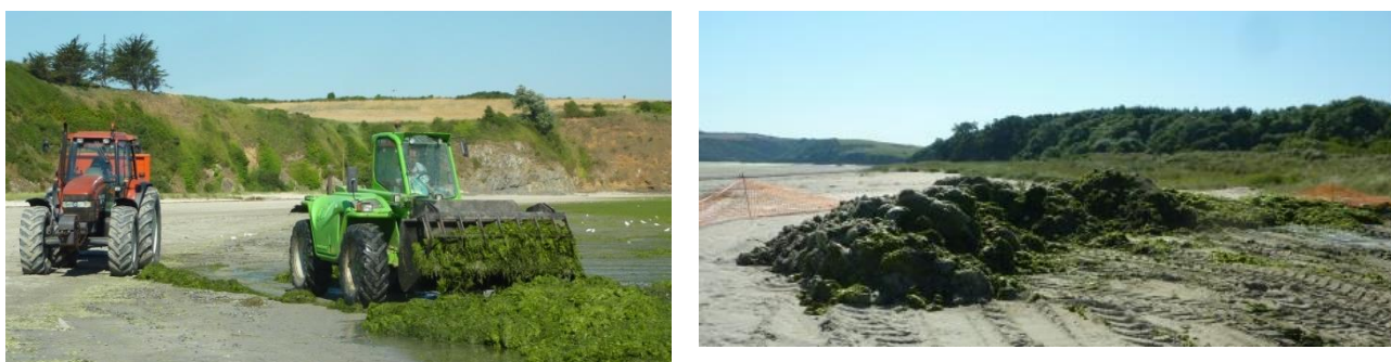
Figure 23 : Engins munis de griffe ramassant les algues vertes à Hillion (à gauche) et zone de ressuyage des algues en haut de cette même plage (22) (source : Neveu, 2016).
