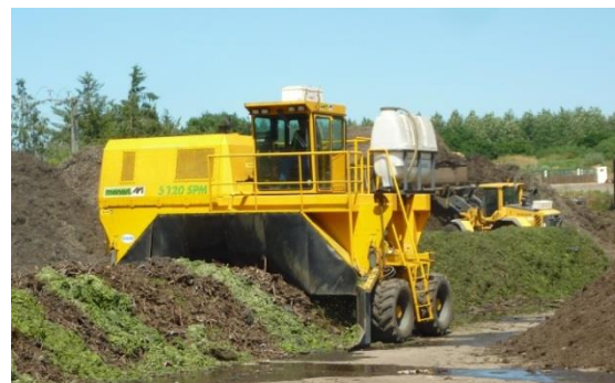
Figure 27 : Retourneur d'andains (ou andaineuse) de l'usine Launay-Lantic (source : Neveu ; 2016).
